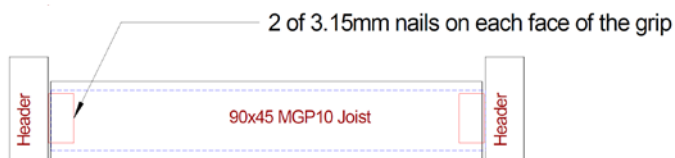
Figure 2 Mini Grip test specimen details
